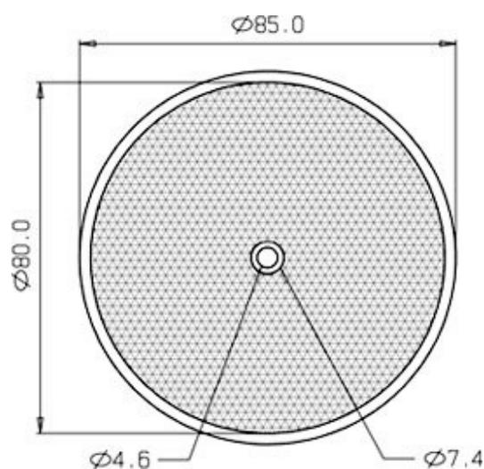
Espelho prismático para Sensores Fotoelétricos por Retro-reflexão.
