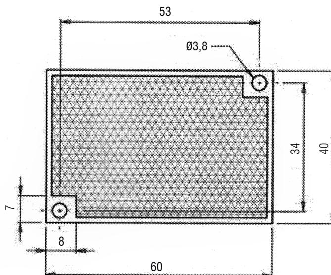
Espelho prismático para Sensores Fotoelétricos por Retro-reflexão.
